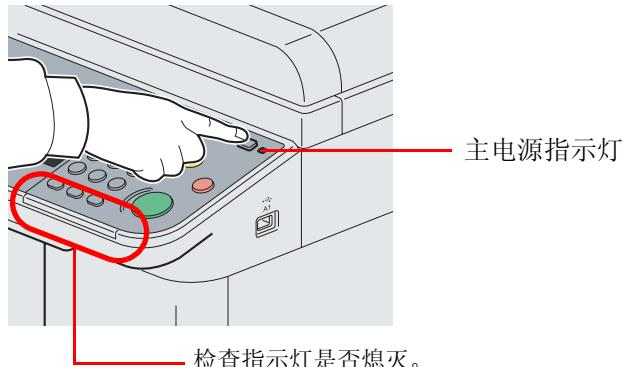
检查确认电源键指示灯已熄灭，主电源指示灯亮起。
