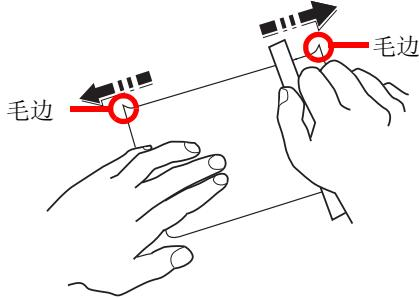
将明信片装入手送纸盘之前,请卷动明信片并且对齐各边。如果明信片弯曲,请将其抚平,然后再装入。在卷曲的明信片上打印可能会造成卡纸。
