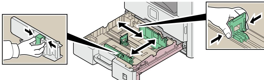
根据要装入的纸张调节纸盒中的纸张尺寸。纸盒上标有纸张尺寸。
