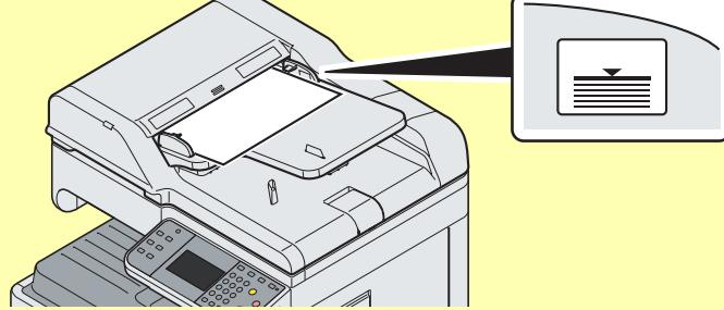
请确认原稿宽度导板是否与原稿完全吻合。如果两者之间存在间隙，请重新调节原稿宽度导板。两者之间的间隙可能会造成原稿卡纸。
