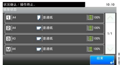
纸张余量以 4 个等级（100 %、70 %、30 % 和 0 %）表示，但是，手送纸盘中的纸张仅以 2 个等级（100 % 和 0 %）显示。如果纸盒中无纸，则纸张状态将显示为无纸。
