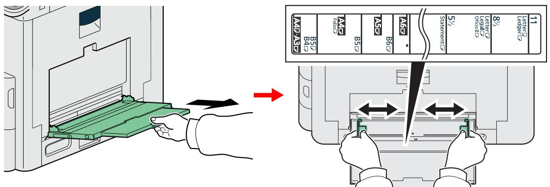
装入尺寸为 A3 至 B4 以及 Ledger 至 Legal 的纸张时，请拉出手送纸盘的支撑托盘部。
