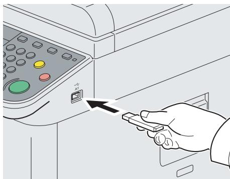
使用 USB 存储器时，将其插入 USB 存储器插槽 (A1)。
