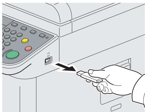
在画面上显示可安全移除可移动内存信息后，按 [确定] 并移除 USB 存储器。
