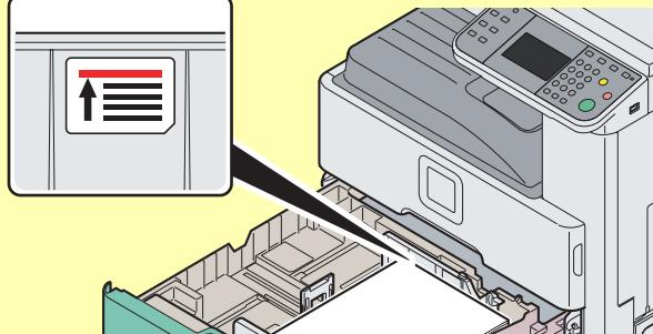
装纸时, 请确保将朝向包装密封侧的一面朝上放置。
